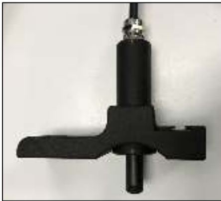
Probe : Rivet hole ECA probe
